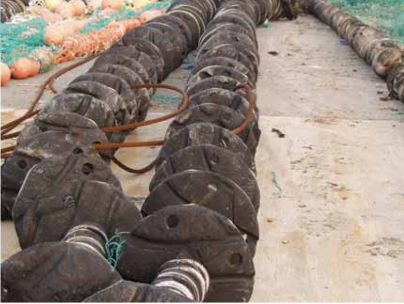
Fanggerät mit Rollen zum Einsatz bei der Grundschieppnetzfisherei.
